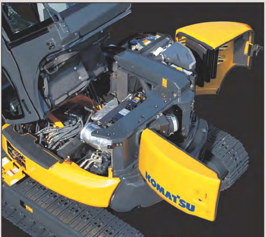
キャブ仕様(オプション 鉄シュー装着車)のチルトアップフロア機構&フルオープンカバー
