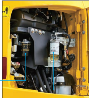
高効率燃料フィルタ ウォータセパレータ機能付 燃料プレフィルタ
