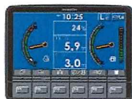
作業半径・掘削・負荷率表示
