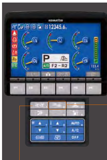
運転モード切り換えスイッチ
