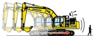
停止状態から旋回するとき、停止制御エリアで人を検知するとキャブ内と外部ブザーが鳴り、旋回の発進を停止させます。
